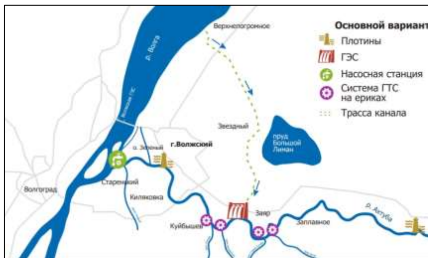
Рисунок 2 – Принципиальная схема дополнительного обводнения
